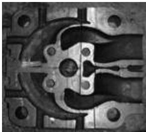
气缸盖采用蠕墨铸铁铸造提高的强度，V型盆腔设计提高了结构刚度和抗冲击性；进排气接口同侧设计结构紧凑；采用切向进气优化进气道结构，使空气燃料混合充分；气阀旋转机构，转阀器控制气阀每分钟转动4~9圈，清除阀线余碳，阀盘接触均匀；四根强力螺栓，液压拉伸安装，利于同侧气道优化布置；水冷阀座，降低阀座表面温度，避免Va、Na高温腐蚀；粉末冶金材料气门导管，具有自润滑功能，防止气阀卡滞。
