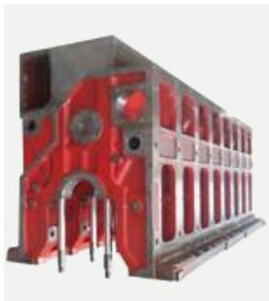
机体采用龙门箱式机体结构刚度好；曲轴悬挂式安装，结构紧凑；主轴承采用侧拉螺栓与主轴承螺栓设计，轴线装配精度高；系统润滑油路、冷却水路、进气管路等均机体内加工或铸造形成，外观整洁，运行可靠安全。
